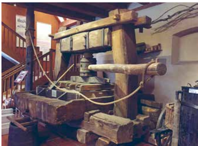
Eine Schraubpresse aus dem 17. Jahrhundert
