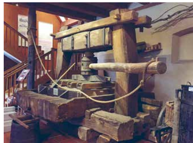
Eine Schraubpresse aus dem 17. Jahrhundert
